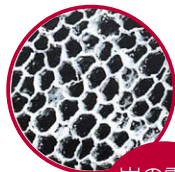
炭の電子顕微鏡写真 (220倍)
